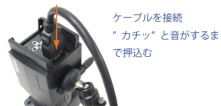
スコープカメラ背面に付属の専用ケーブルを接続します。
