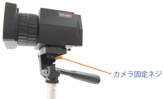
CCD カメラを三脚にネジで固定します。
