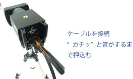
CCD カメラ背面に付属の専用ケーブルを接続します。
