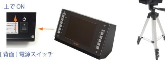
マルチスイッチャー背面の電源スイッチを ON にすると、液晶モニ
